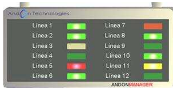
Figura 1.11 Ejemplo de panel Andon con código de colores que indica el estado de producción de las diferentes líneas.
