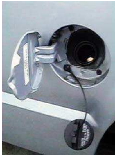
Figura 1.8 Ejemplo de diseño de la boca de un depósito de combustible siguiendo los principios Poka Yoke.
