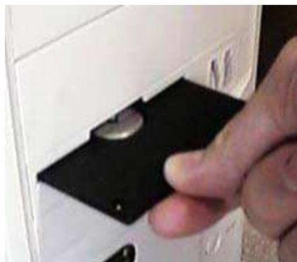
Figura 1.9 Ejemplo de diseño de la entrada de una diskettera siguiendo los principios Poka Yoke.
