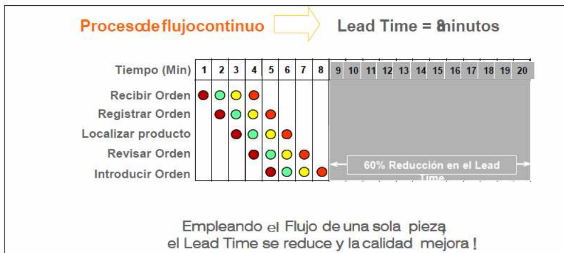
Figura 1.4. Representación del tiempo necesario para realizar una producción basada en un proceso continuo (lotes de 1 pieza).
