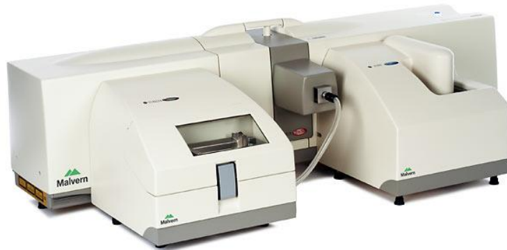
Figura 6. Mastersizer 2000, conectado por la vía seca (fuente: malvern.com)
