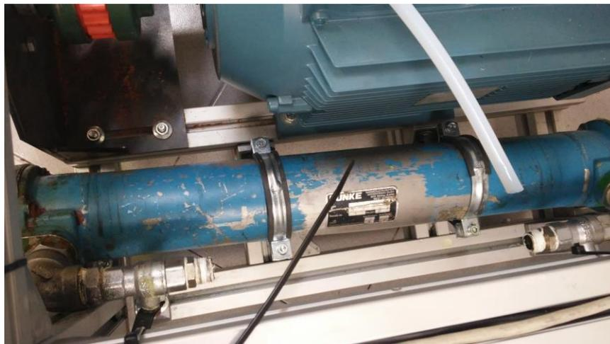
*Figura 18 Intercambiador de calor*
