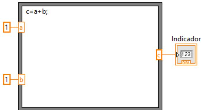
Figura 4. Ejemplo de funcionamiento del Formula node.
