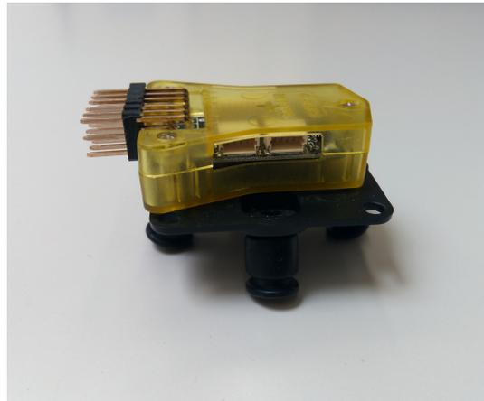
*Figura 4. Sensor inercial modelo CC3D.*
