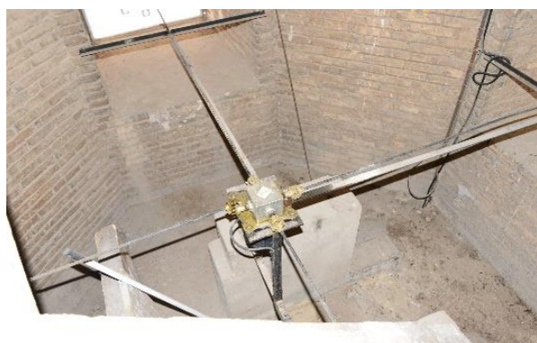
Figura 108: Mecanismo del reloj del campanario. Fuentes propias
