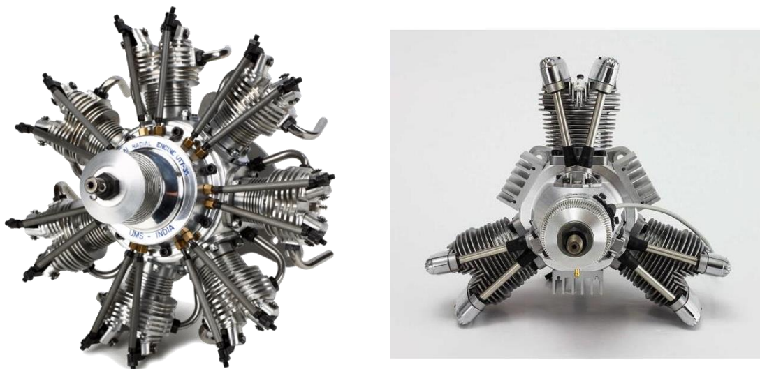
Figura 2.3 Motores en disposición radial.[4] y [6]
