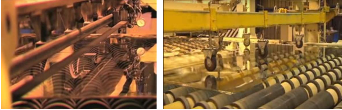
Ejemplo de cuchilla marca transversalmente el material y posteriormente con movimiento seco, se separan las piezas de vidrio
