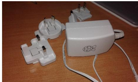
Fig. 11: Cargador y adaptadores
