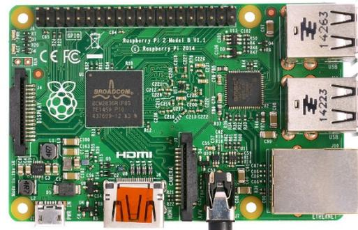
Fig. 4: Raspberry Pi 2 Modelo B
