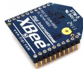
Ilustración 4. Modulo Xbee S1 [23]
