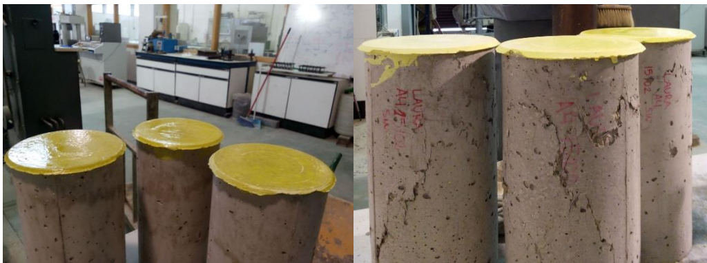
Figura 67. Probetas recién refrentadas en la imagen de la izquierda y probetas refrentadas ya ensayadas a compresión en la imagen de la derecha.
