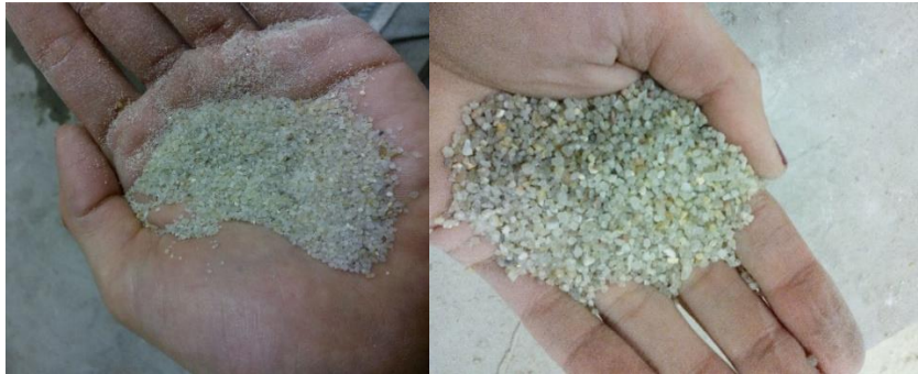
Figura 50. Fotografías de la arena 0,4 mm (izquierda) y de la arena 0,8 mm (derecha) utilizadas para la fabricación de UHPFRC.
