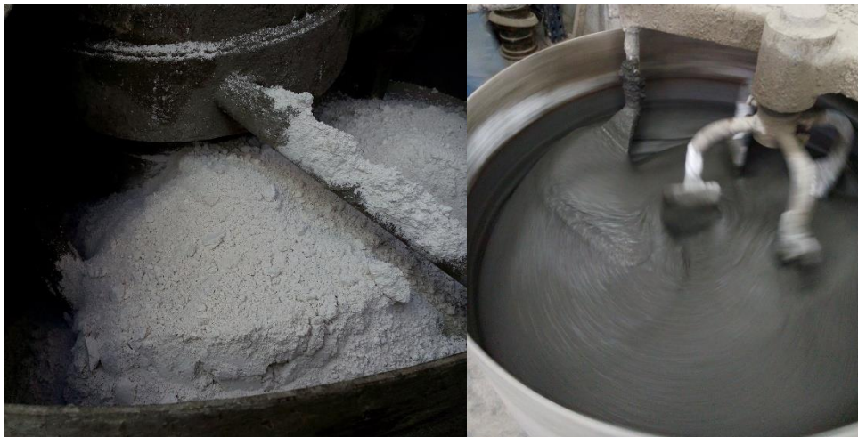
Figura 59. En la figura de la izquierda se observa el momento de la adición del superplastificante, mientras que en la derecha se puede observar cómo ha cambiado ya el aspecto del hormigón.
