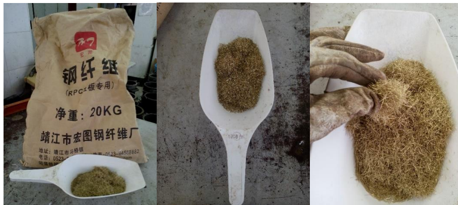
Figura 54. Fibras metálicas de 12mm y alto límite elástico usadas para los hormigones UHPFRC.
