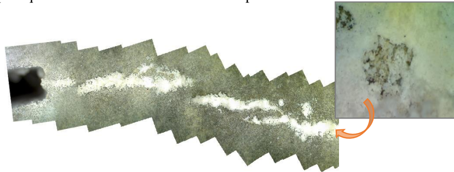
Figura 80. Imagen compuesta (izquierda) y detalle (derecha) mediante fotos tomadas con el microscopio de una fisura después de la introducción en el ambiente de sanado.
