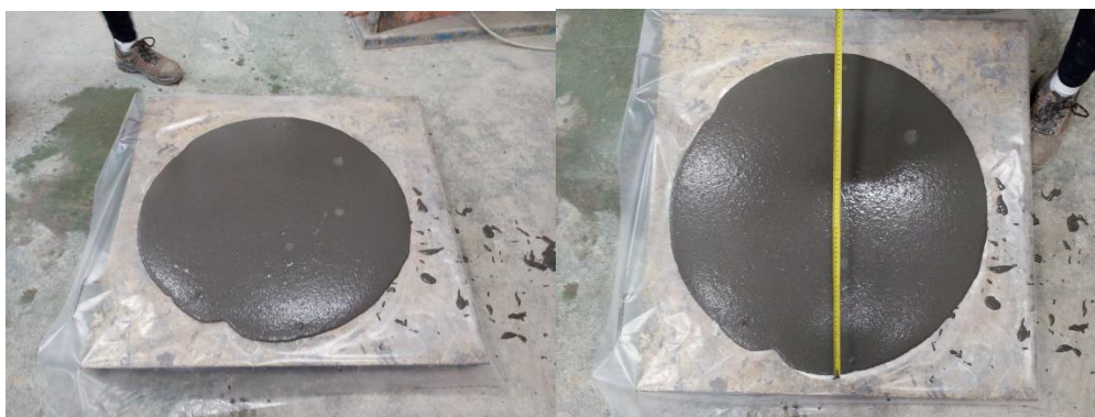
Figura 65. Medida de la consistencia de los hormigones de muy alto rendimiento (UHPFRC).
