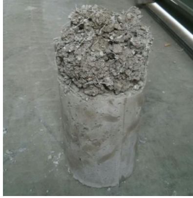
Figura 94. Probeta con fraguado acelerado de la amasada A8.
