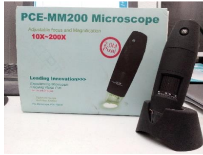
Figura 84. Microscopio PCE-MM200 utilizado para las fotografías de las fisuras.
