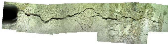
Figura 79. Imagen compuesta mediante fotos tomadas con el microscopio de una fisura antes de la introducción en el ambiente de sanado.
