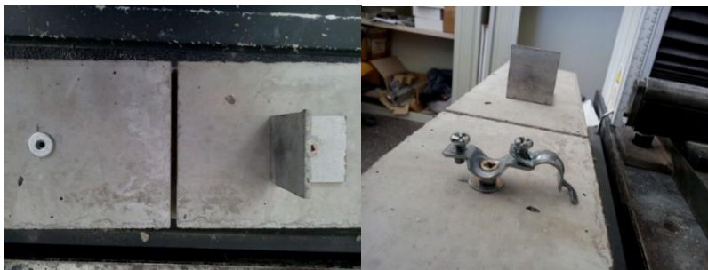
Figura 70. Preparación de la probeta para la colocación de la galga extensiométrica.
