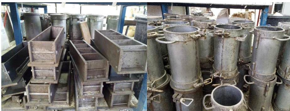
Figura 57. Moldes para la fabricación de probetas prismáticas y cúbicas (izquierda) y probetas cilíndricas (derecha).
