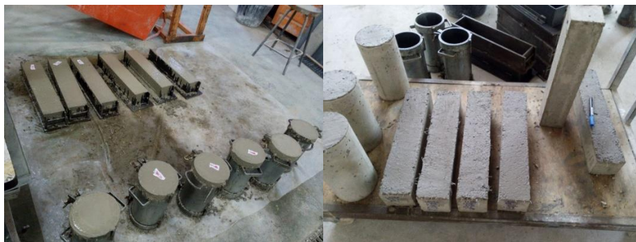
Figura 61. Probetas fabricadas. Probetas con el hormigón aún fresco (izquierda) y probetas desmoldadas que están siendo preparadas para almacenar en cámara de humedad (derecha)
