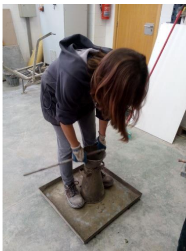
Figura 63. Imagen del proceso de relleno del cono de Abrams.
