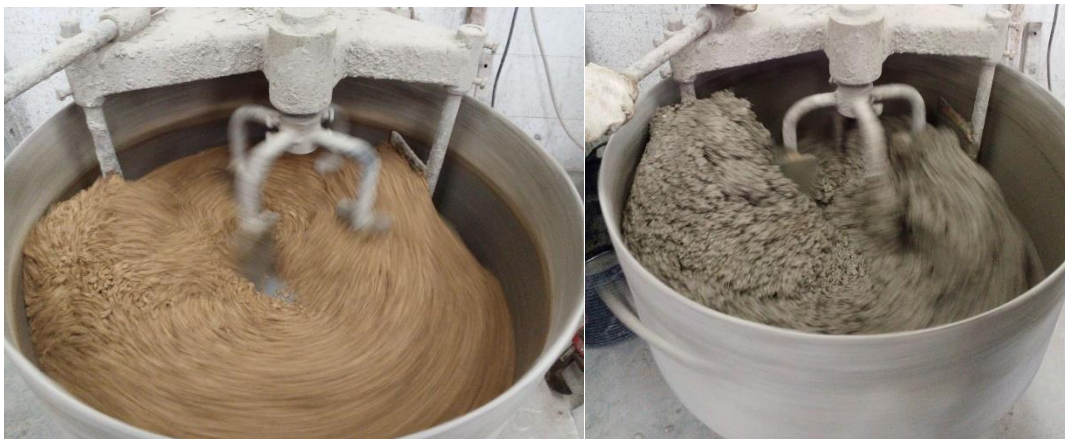
Figura 58. Foto de la fase 3 (amasado de los áridos junto con la mitad del agua) en la fotografía de la izquierda y amasado de los áridos, el agua tota, el cemento y el superplastificante correspondiente a la fase 6 en la derecha.
