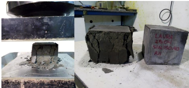
Figura 95. Probeta cúbica de UHPFRC CCA a 2 días con retraso de fraguado (izquierda) y comparación entre la probeta con retraso de fraguado y una probeta de las mismas características sin Aditivo Cristalino. Edad de las probetas 2 y 3 días respectivamente (derecha).
