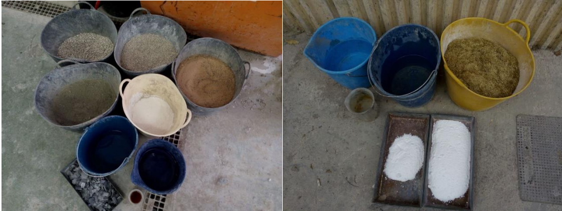
Figura 56. Material separado para la fabricación de hormigón SQ-FRC o HQ-FRC a la izquierda y parte del material separado para la fabricación de hormigón UHPFRC a la derecha.
