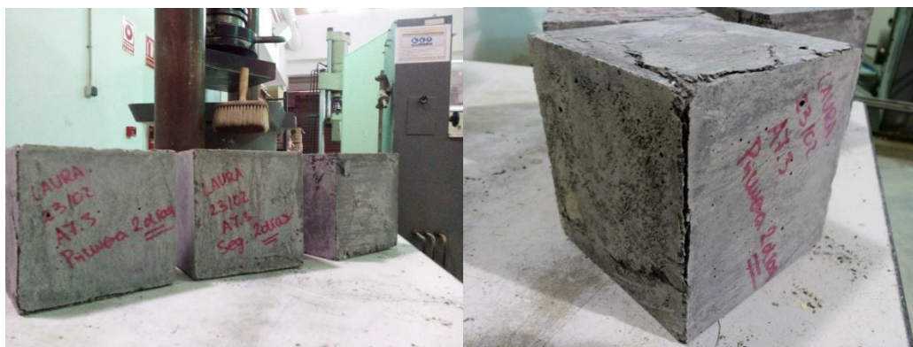
Figura 68. Probetas cúbicas de hormigón de muy alto rendimiento después de romperlas a compresión (izquierda y derecha).
