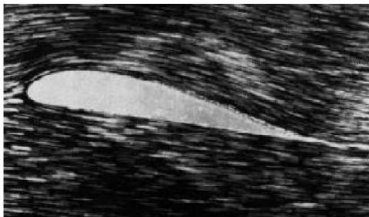
Figura 4. Capa límite adherida al perfil
