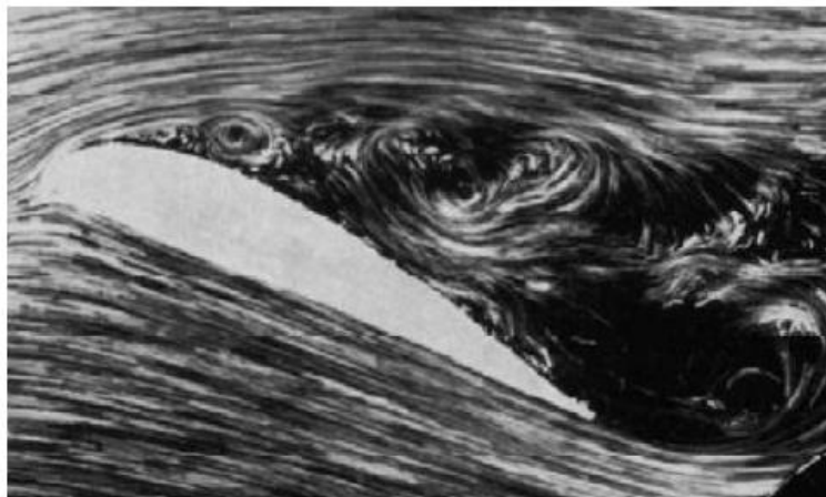
Figura 6. Perfil con capa límite desprendida
