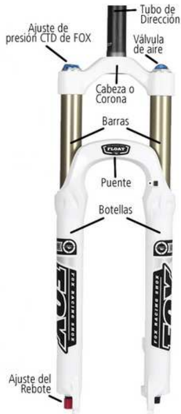
Fig 3.9.- Partes de la horquilla
