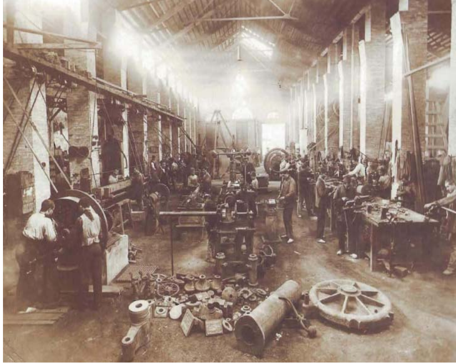
Figura 2: Nave de tornos y ajuste de una fundición (indeterminada) a principios del XX. Archivo José Huguet. Fuente: (Álvarez Rubio, 2001).
