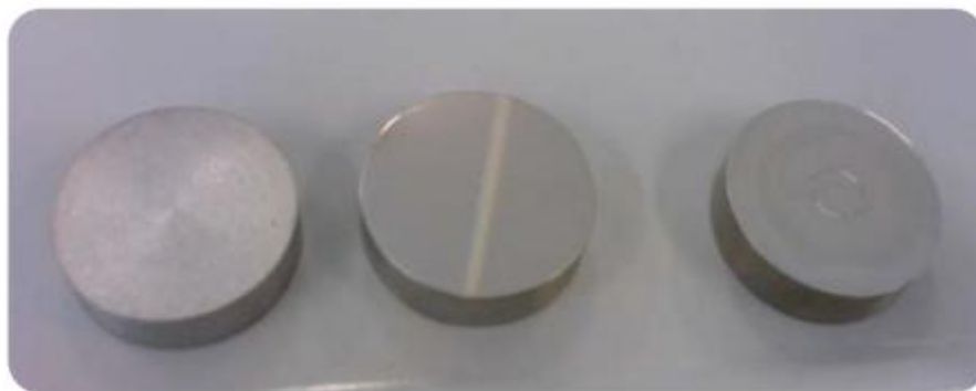
Figura 9. Electroodos de trabajo antes del pulido.
