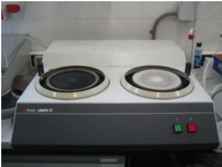
Figura 10. Lijadora-Pulidora Struers LaboPol-21
