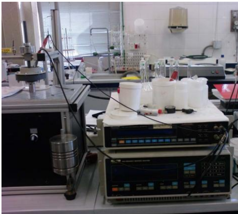
Figura 16. Conexión de los electrodos al potenciostato-analizador SOLARTRON
