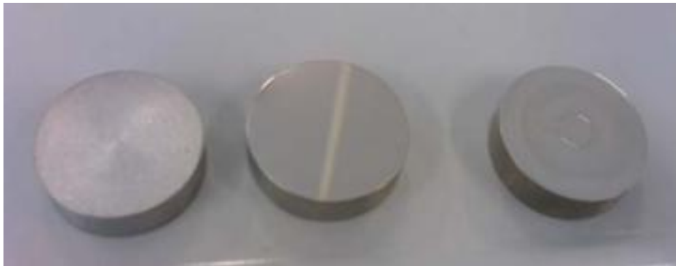
Figura 11. Electrodo de trabajo antes del pulido (izquierda), después del pulido (centro), y después del ensayo tribológico (derecha).
