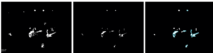
Imagen 10. Aplicación de los filtros para la eliminación del ruido y favorecer la posterior detección. De izquierda a derecha: imagen binaria, tras aplicar el filtro erode y finalmente tras aplicar el filtro dilate. Se puede observar que la mayor parte de pequeñas manchas aisladas desaparecen tras el filtrado.
