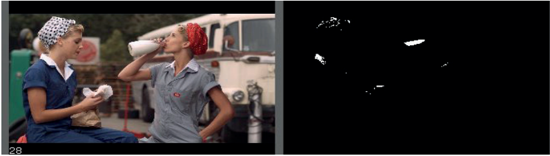
Imagen 9. Brightness Thresholding. A la izquierda se encuentra el fotograma analizado y a su lado el resultado del análisis de brillo, donde las manchas blancas corresponden a las zonas de la imagen original con un valor de brillo superior al umbral establecido.
