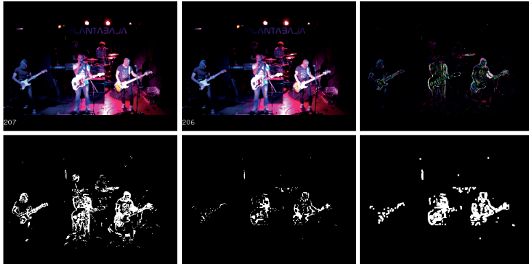
Imagen 11. Pasos aplicados para la discriminación de movimiento con el algoritmo Frame Differencing. De izquierda a derecha. Arriba: fotograma actual, fotograma anterior y diferencia absoluta entre ambos. Abajo, tras aplicar sucesivamente umbral, erode y dilate.
