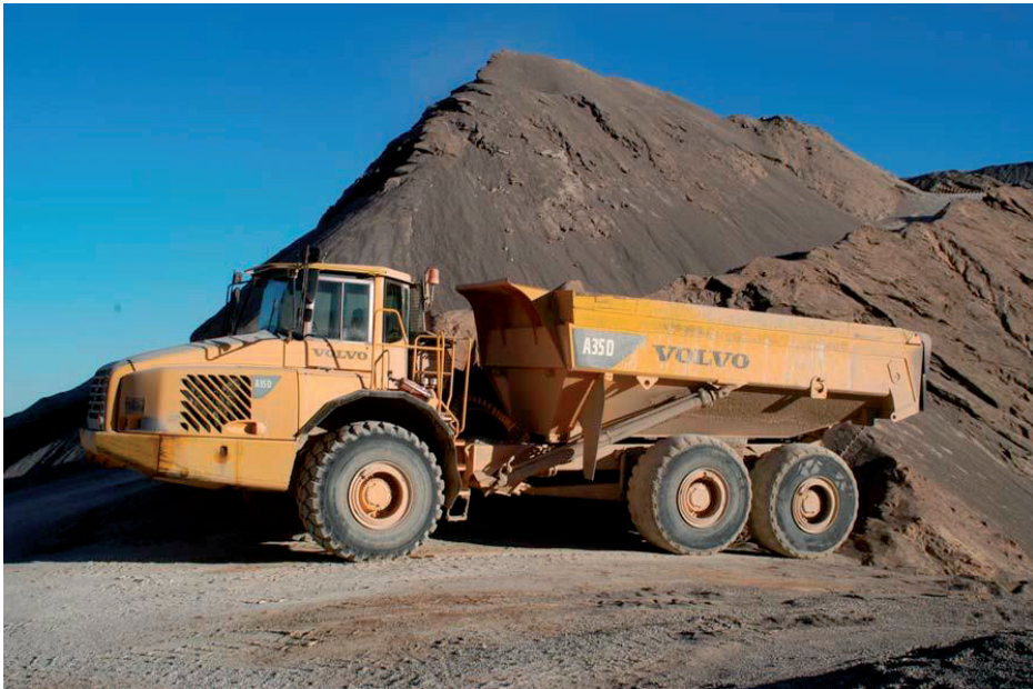
Imagen 1. Maquinaria de movimiento de tierras: dúmper articulado
