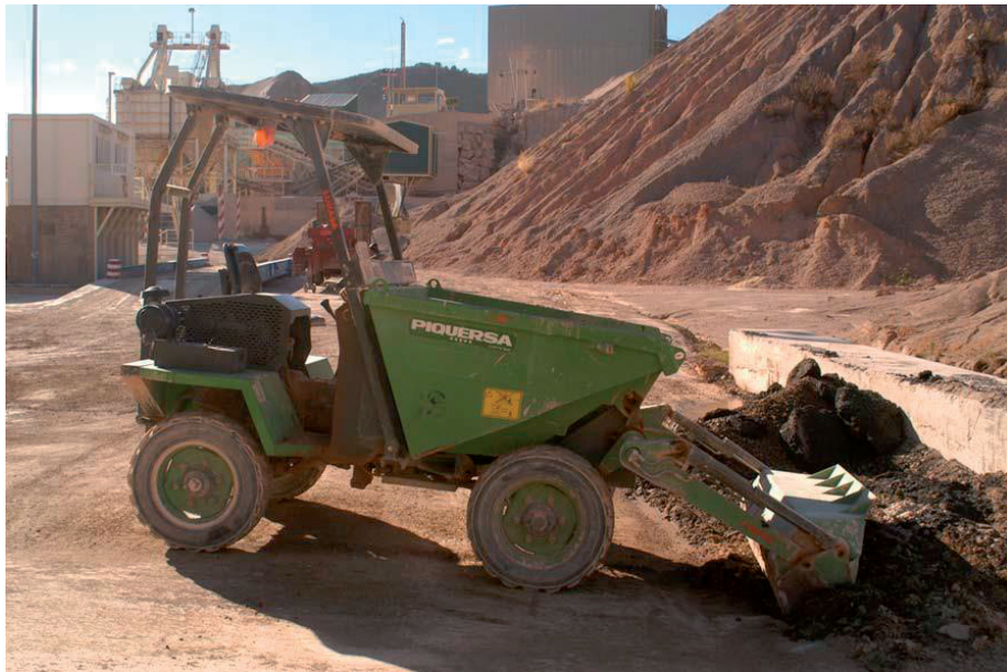
Imagen 3. Maquinaria auxiliar, habitual en alquiler: Autovolquete
