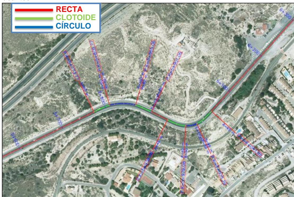
Figura 6.- Ejemplo ajuste de curvas en el Autocad Civil 3d
