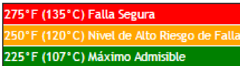
Figura 5.6: Temperaturas críticas de descarga. Fuente: [10]
