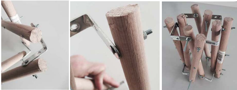
Fig. 4 Muestra el montaje y estado final de un módulo de la estructura desplegable.
