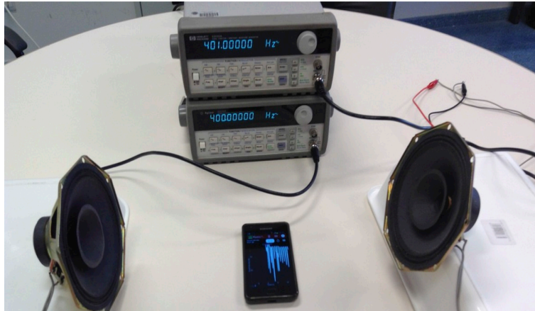
Fig. 6 Montaje experimental para la medida del batido acústico.
