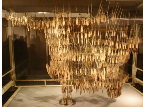
Fig. 3 Funicular utilizado por Gaudí para calcular la Sagrada Familia
