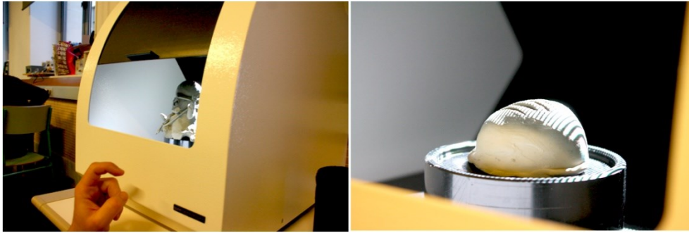
Figura 7. Utilizando un escáner 3D de luz estructurada para digitalizar las superficies de las piezas modeladas.
