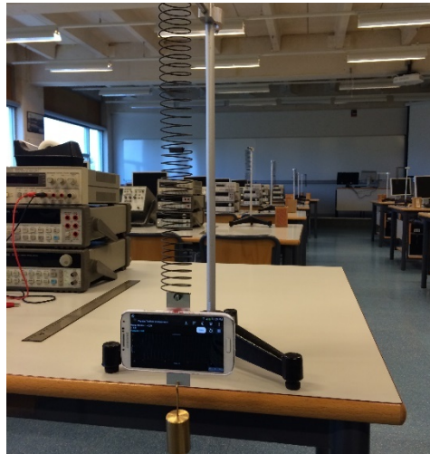
Fig. 2 Detalle de la colocación del teléfono móvil para la realización de la práctica
