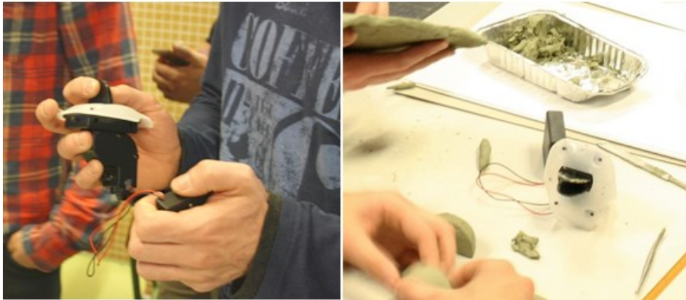
Figura 8. Módulo electrónico motorizado utilizado para dotar de movimiento el modelo de arcilla.
