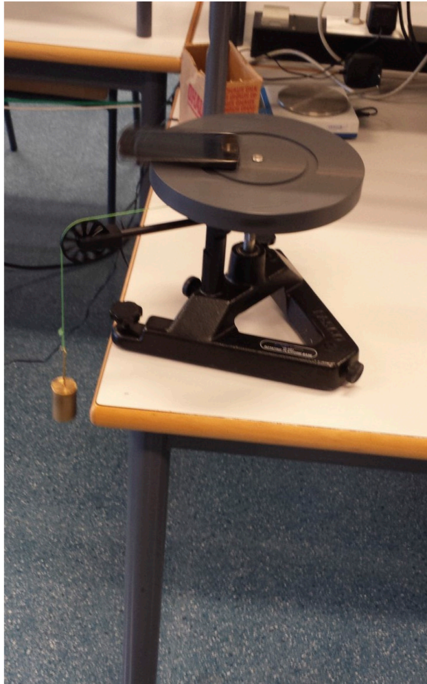
Fig. 3 Colocación del teléfono móvil para la realización de la práctica
