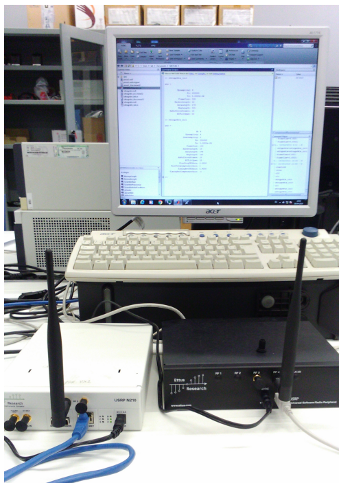
Fig. 3: Maqueta de una de las evaluaciones de transmisión con modulación QPSK perteneciente al Lab3
