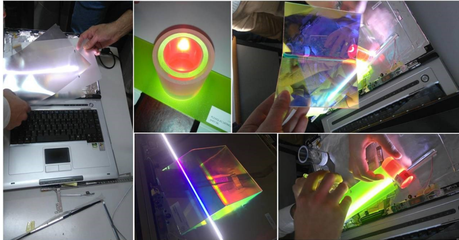
Figura 4. Tubo de cátodo frío extraído del portátil y en funcionamiento. Se experimenta con el PMMA de varios colores para conseguir diferentes efectos lumínicos
