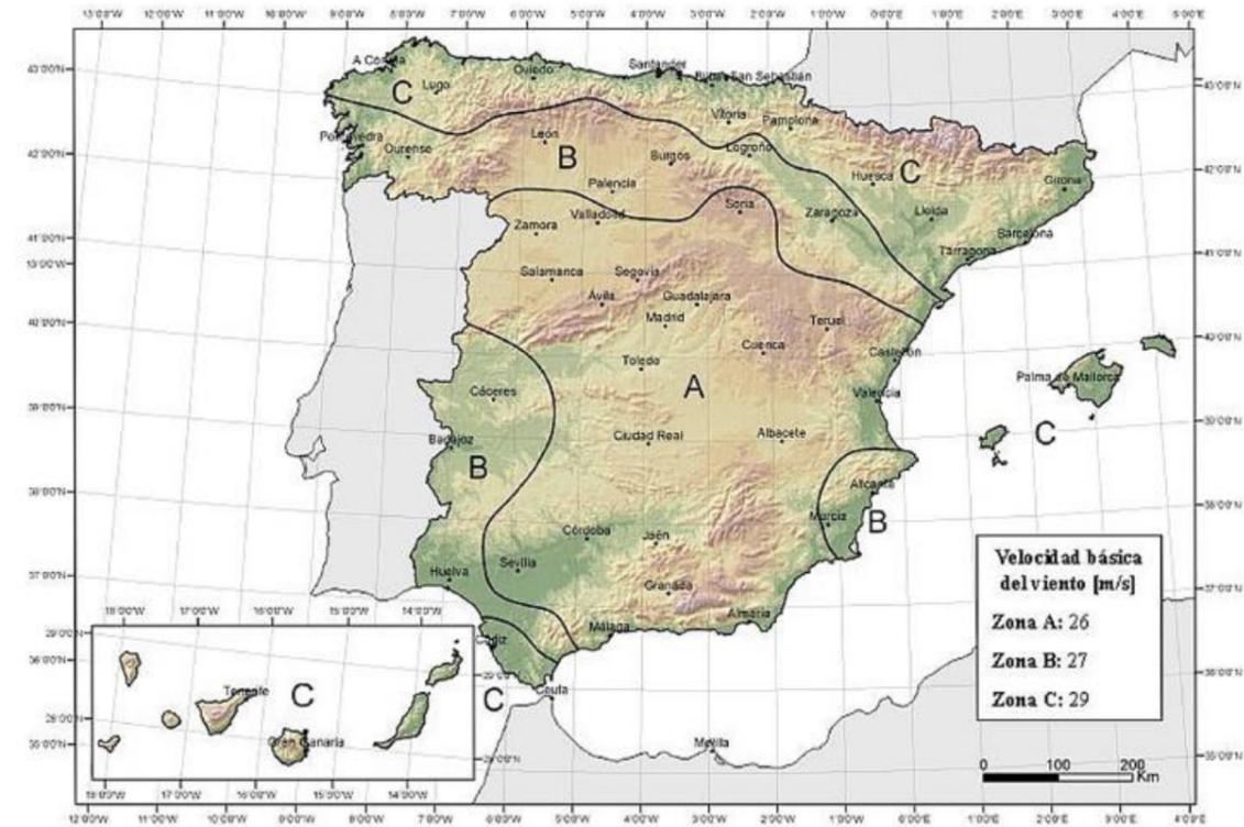
Figura 10. Mapa de isotacas para la obtención de la velocidad básica fundamental del viento
