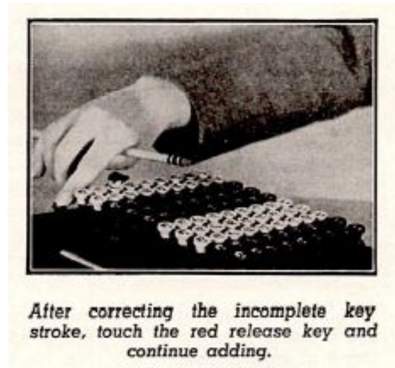
Figura 3.10: «Després de corregir l'error de pulsació de tecla polsa el botó roig d'alliberament y continua sumant».
