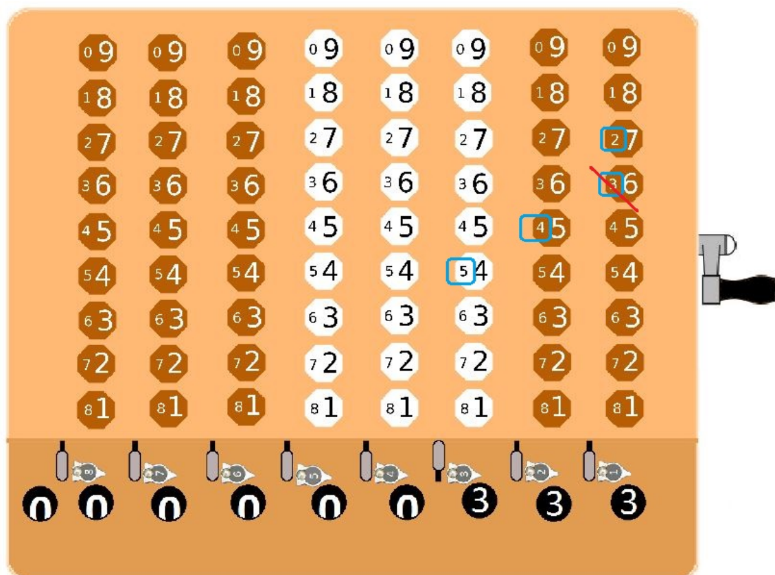
Figura 4.35: El següent pas és introduir el subtrahend (543) però amb els números xicotets que es troben a les tecles. Cal anar en compte en l'última xifra del subtrahend ja que es té que introduir restant-li 1.
