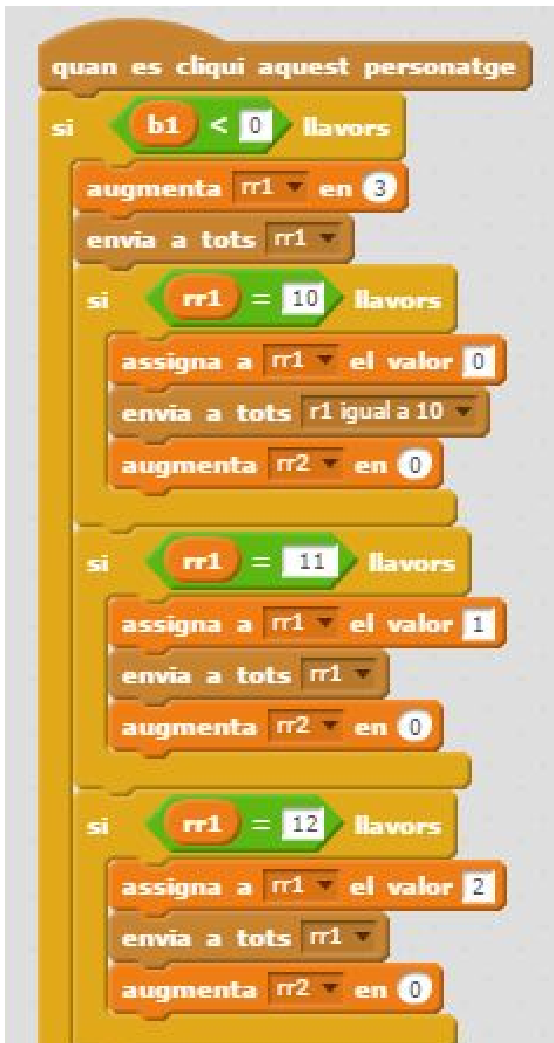
Figura 4.27: Al pulsar l'inhibidor de la resta el valor de b1 és igual a -1 i és quan la tecla detecta que es va a realitzar una operació de restar. Al ser el valor -1 entra per la primera condició i suma 3 al registre (en aquest cas al registre 1). Envia un missatge al registre 1 avisant de que el valor del registre 1 ha canviat a 3, després el registre sols tindrà que canviar el vestit actual pel vestit igual al valor del registre (en aquest cas el 3). No obstant això, els valors del registre 1 poden ser en aquest cas per a la tecla 3 de 10, 11 i 12. Al utilitzar els inhibidors de la resta, aquests eliminen el préstec (si hi ha) de la resta, per tant si el valor és 10, 11 i 12 sols apareix al registre el valor de les unitats, que serien o bé 0, 1 o 2. Aquestos valors s'envien al registre corresponent i és aquest l'encarregat de canviar el vestit.
