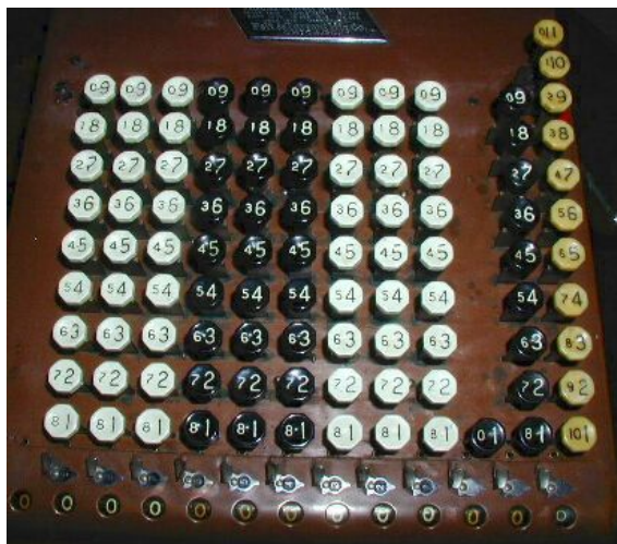
Figura 3.3: Model F format per 12 columnes per a poder realitzar principalment càlculs amb lliures esterlines.
