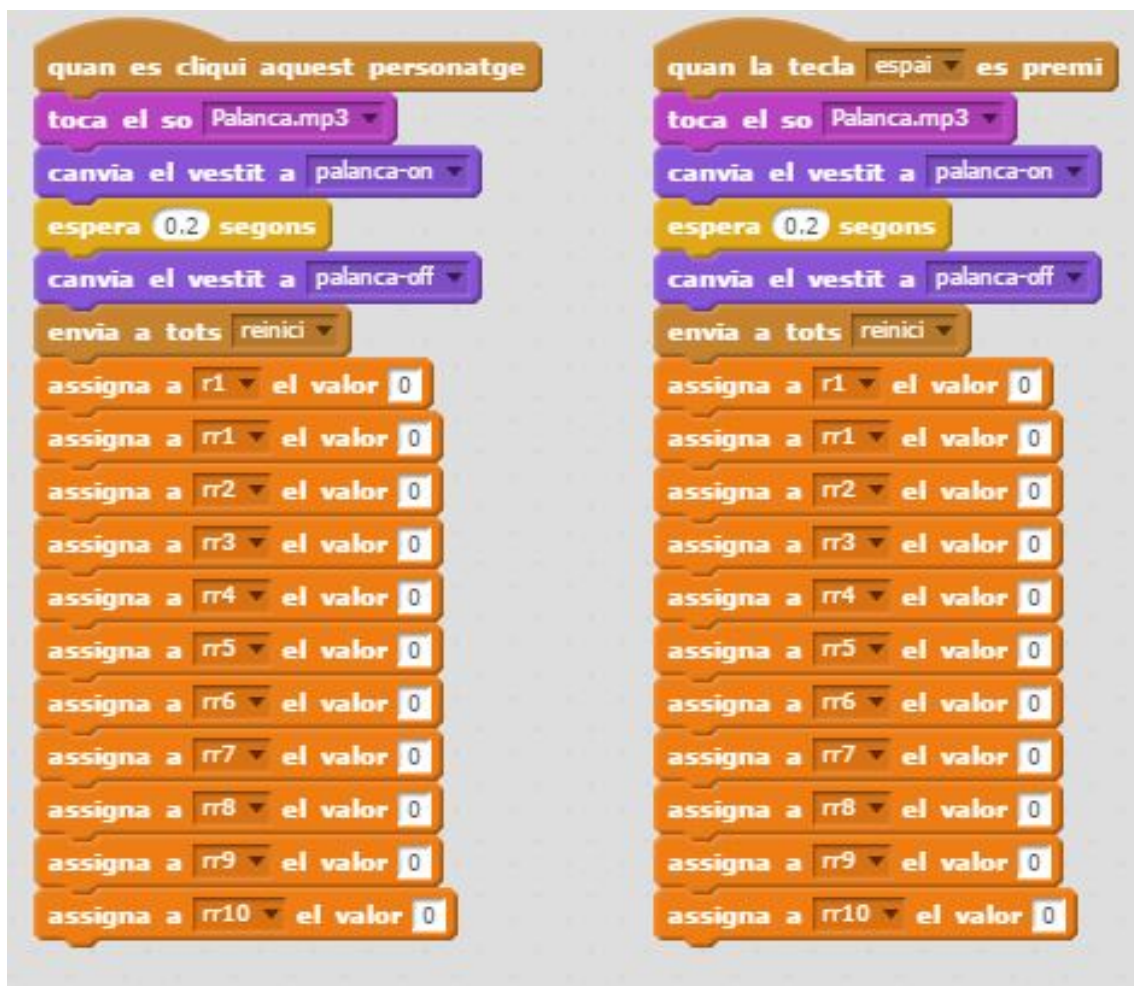
Figura 4.21: Quan es polsa l'objecte de la palanca o la tecla d'espai al teclat, es genera el so de reiniciar i al mateix temps la palanca canvia d'estat (de l'estat off a on) i torna al seu estat inicial. Després envia un missatge «reiniciar» a tots els registres per a indicar que aquestos tenen que canviar el seu vestit actual al vestit inicial (zero). Una vegada els registres reben aquest missatge, els valors de cada registre també s'inicialitzen a zero.
