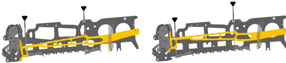
Figura 3.13: El recorregut de polsar la tecla 9 (figura esquerra) és més gran comparat al recorregut si polsem la tecla 1 (figura dreta).
