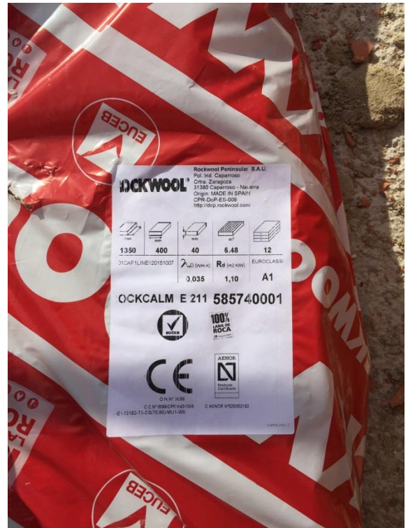
1.6 Comprobación de las características técnicas de la Lana de Roca colocada.
