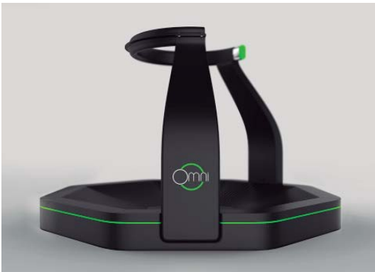
Fig 4.4 Prototipo de dispositivo de entrada Omni, encargado de trasladar la dirección y velocidad de los pasos del mundo real a los mundos virtuales
