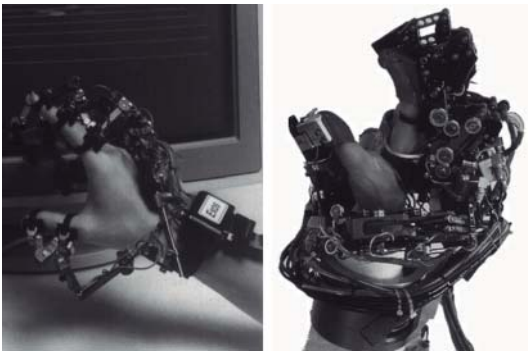
Fig 4.3 Dispositivo de entrada DHM (Dexterous Hand Master). Sistema de seguimiento de movimientos mecánico
