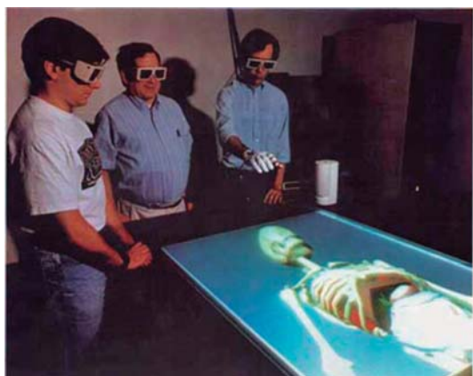
Fig 4.11 Dispositivo Woekbench, para trabajar con modelos tridimensionales. En la imagen, aplicación médica
