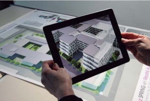
Fig 3.1 Soporte de realidad aumentada, consistente en añadir información virtual al mundo real. En la imagen, virtualización de un modelo 3D adjunto a planos físicos.
