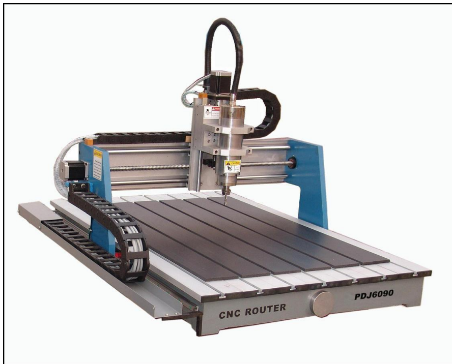
Figura 1.1: Fresadora CNC de tres ejes (para piezas de aprox. 40x30cm)
