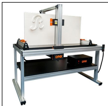
Figura 2.3: Máquina CNC de corte por hilo caliente
