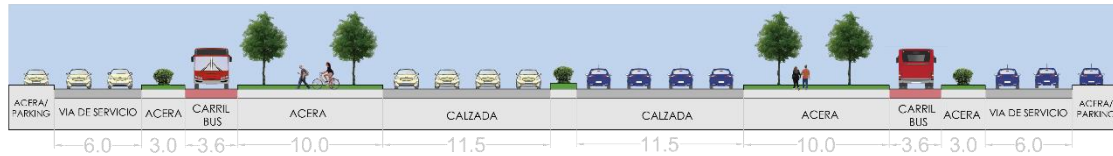
Ilustración 45. Sección Avenida de les Cortes Valencianes
