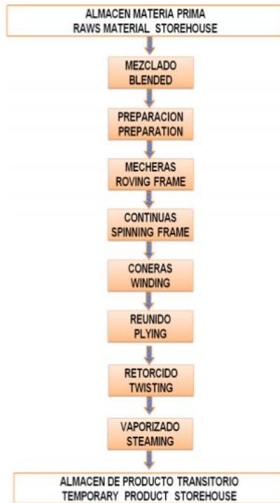
Imagen 3. Diagrama de Proceso de la Planta de Hilandería.
