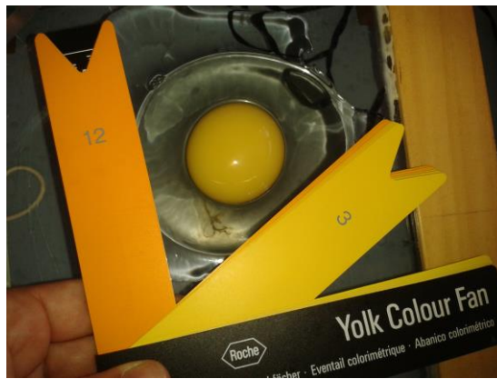
Figura 18. Escala Roche para evaluar el color de la yema del huevo.
