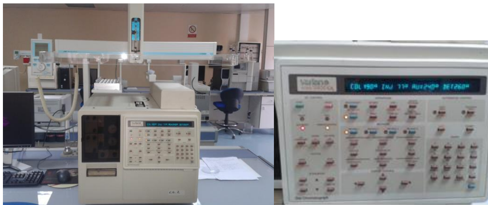
Figura 21. Cromatógrafo de gases para determinación del perfil lipídico de la grasa y detalle de las condiciones de lectura.
