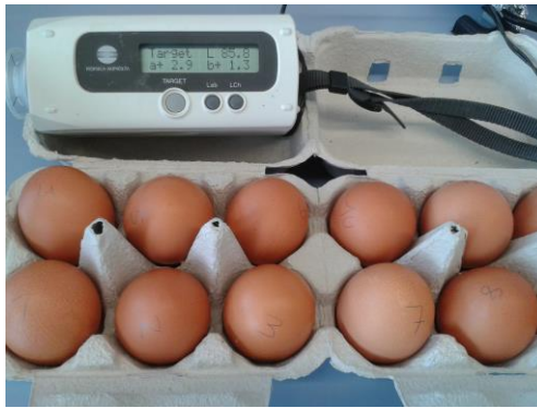
Figura 22. Mediciones del colorímetro en la cáscara del huevo.
