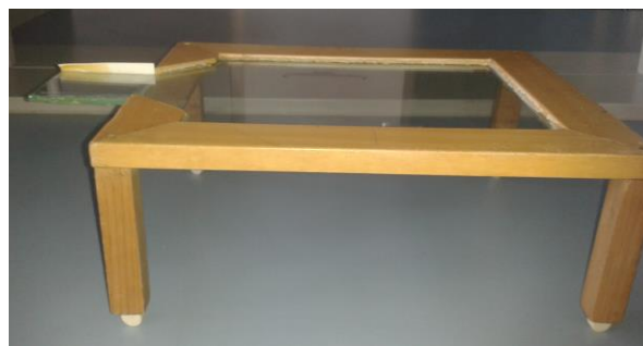
Figura 17. Mesa transparente para evaluación de calidad del huevo.
