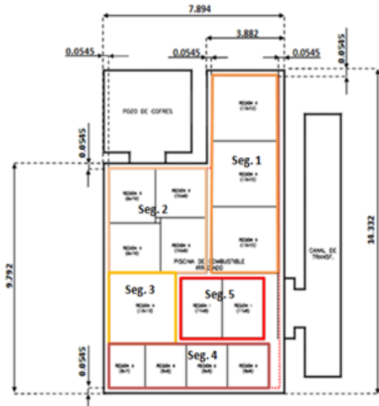
Fig 1. Plano X-Y. Esquema de la piscina de Ascó Fig2. Plano X-Y. Modelo implementado en Trace
