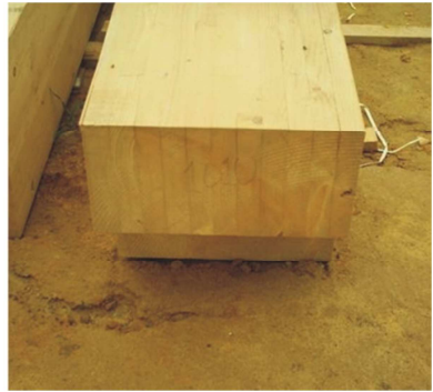
Imagen 31. Acopio en obra de madera aserrada. Viga de madera laminada. 2006. Fuente: Propia.
