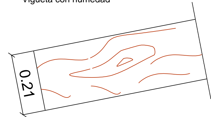
Vigueta tras lijado y retirada de material con humedad
