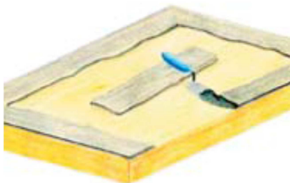
Imagen 34 y 35. Pegado de borde-punto en una plancha de MW (izda) y en una plancha de EPS (dcha)
