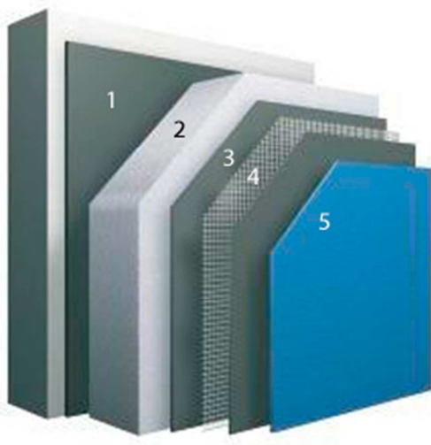
Imagen 22. Componentes del SATE fachada no ventilada.
