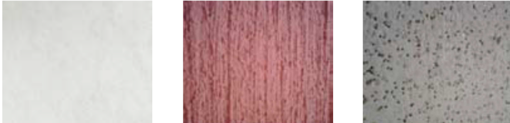
Imagen 75. Textura con efecto dado por rodillo de trapeado, con efecto por llana dentada triangular y liso con árido proyectados.
