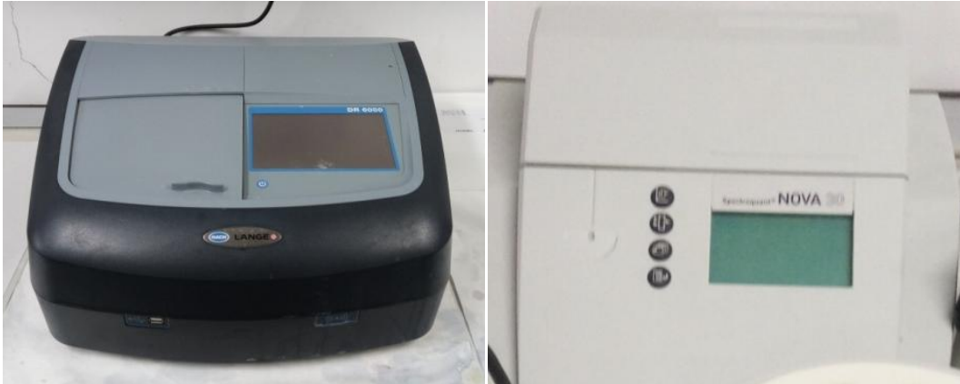
Figura 25. Espectrofotómetro Hach (izq.) y espectrofotómetro Merck (der.).
