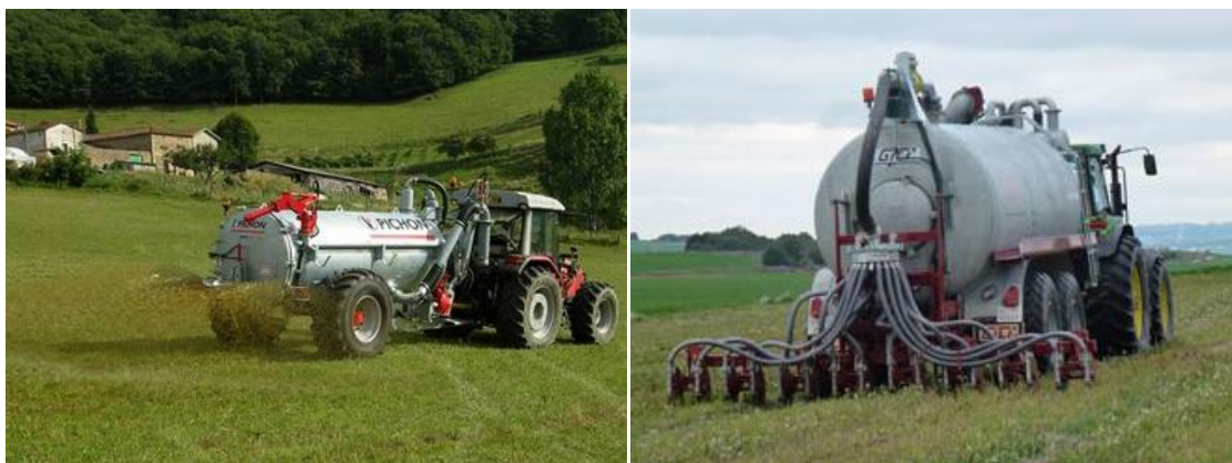
Figura 3. Esparcidor de purines (izq. Fuente: Durán Maquinaria Agrícola, S.L.) y aplicador de purines (der. Fuente: Talleres Gili 98).
