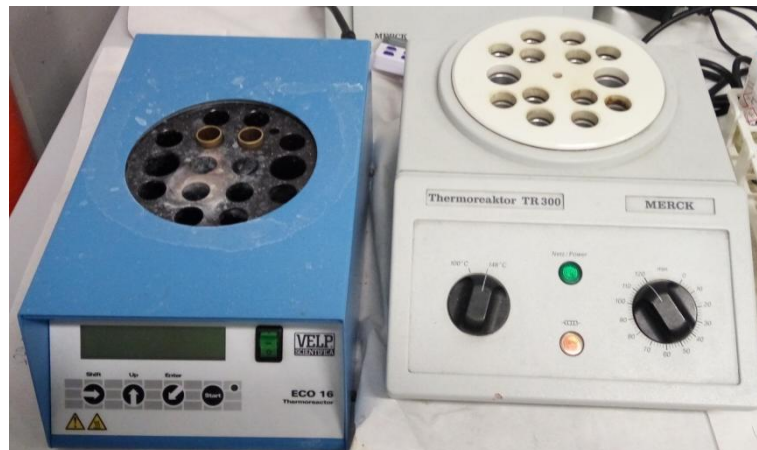
Figura 26. Termorreactor marca Velp, modelo ECO 16 (der.) y termorreactor marca Merck, modelo TR 300 (izq.).
