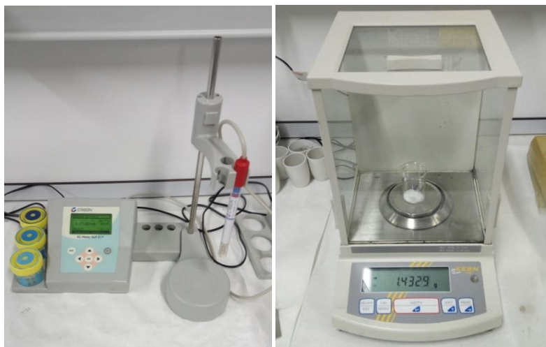
Figura 18. pH-metro Crison modelo GLP +21 (izq.) y balanza Kern, modelo ABJ-NM (der.).
