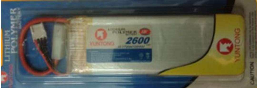
Batería LI-PO de 2600 mAh
