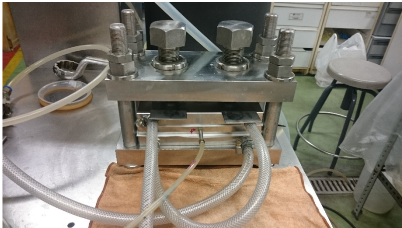
Figura IV.5. Detalle de la planta piloto: módulo de membranas
