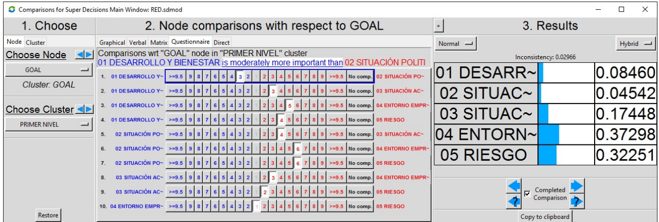
Figura 69 - Cuadro de diálogo de comparación pareada, Cuestionario (izq) ya resuelto por el decisor donde se aprecia el peso final de los criterios de primer nivel (dcha). Fuente: elaboración propia.
