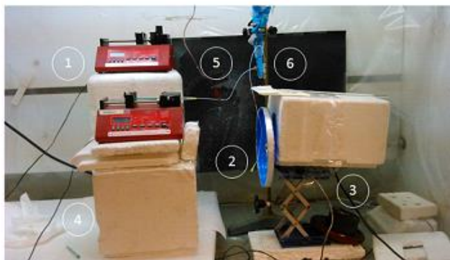
Figura 19. Montaje experimental del sistema de electrospinning coaxial para la producción de nanofibras alineadas rellenas de disolución de boro al 10%.
