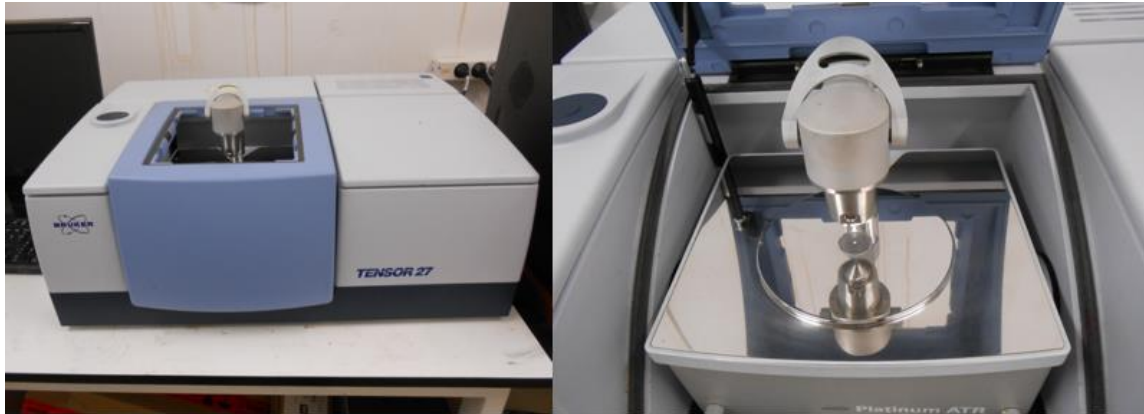
Figura 23. Espectrofotómetro infrarrojo TENSOR 27 empleado en la caracterización química de los soportes materiales fabricados.
