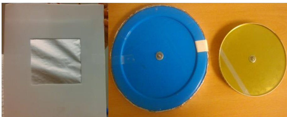
Figura 17. Collectores home-made para el electrospinning . A la izquierda, un colector plano recubierto de una lámina de teflón (nanofibras Aleatorias ). A la derecha dos colectores rotatorios (nanofibras alineadas ): el primero de poliestireno, perforado por un tornillo, empalmado con hilo de cobre y recubierto de papel de aluminio para volverlo un material conductor que atraiga las nanofibras y, el segundo, es íntegramente de latón por lo que ya aporta conductividad al material base.
