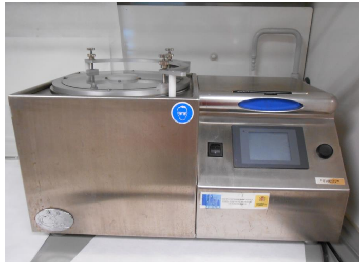
Figura 16. Spin coater modelo CEE R 200X conectado a un sistema de vacío en una cabina con atmósfera inerte (N 2 )
