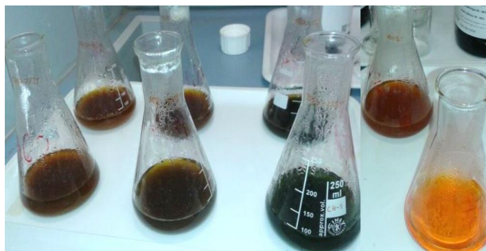
Figura 3.8: Pas previ a la valoració: (De dreta a esquerra) Davant: assaig en blanc, 75%V,50%V i 25%V; Darrere: 100%T,75%F.C i 25%F.C
