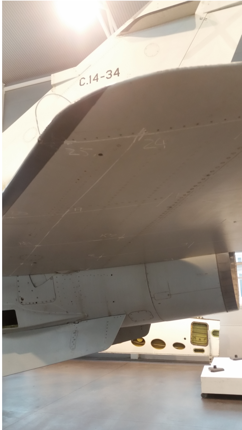
Figura 13.4: Malla dibujada en el estabilizador
