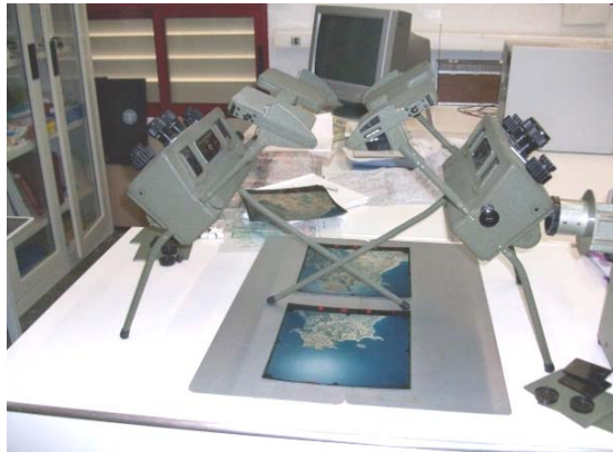
Figura 6. Estereoscopi d'espills amb joc de lupes i binoculars
