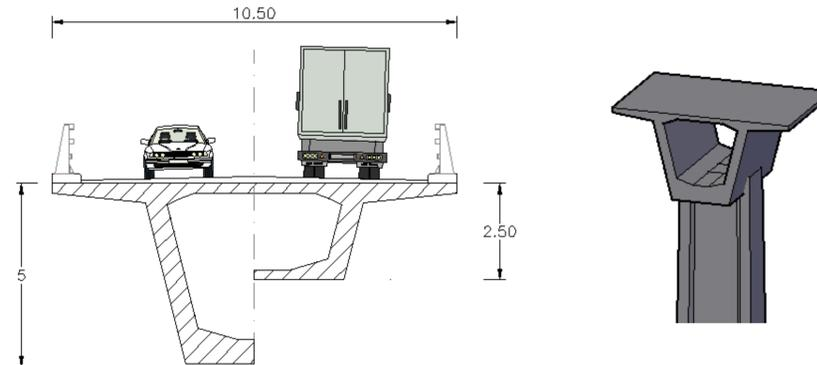
El tablero presenta un ancho total de 10,5 metros, el cual se divide en dos carriles (uno por sentido) de 3,5 metros cada uno, para una velocidad de proyecto de 60 km/h, arcén lateral de 1 metro y un sobrecanto de 0,75 metros a cada lado sin pavimentar para albergar los pretiles de seguridad.
