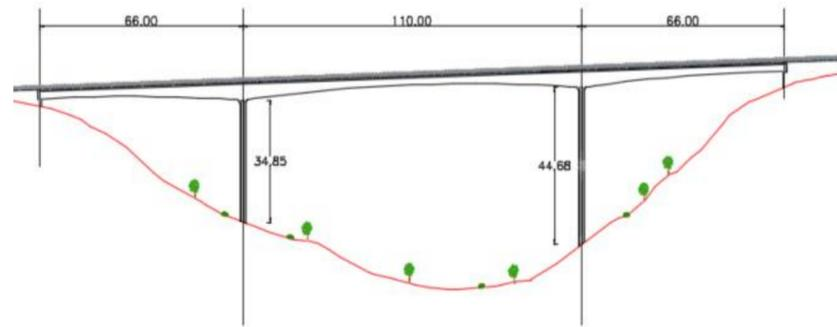
El tablero del puente se ha planteado como una solución continua compuesta por dovelas de 5 metros de longitud excepto la dovela de arranque con 7 metros, solidarizado mediante cable de continuidad en dovela central.
