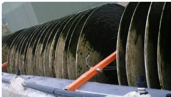
Figura 2: microalgues a un fotobiorreactor de biodiscos.
