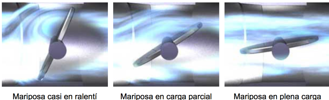
FIGURA 4.16: POSICIONES LAS CUALES PUEDE TENER UNA MARIPOSA DE ADMISIÓN.
