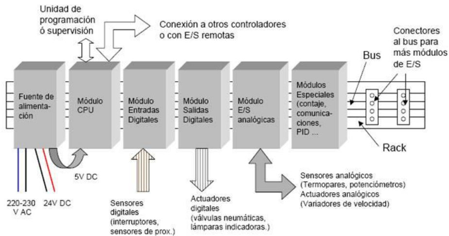
Estructura externa de un PLC Omron (Fig. 2)
