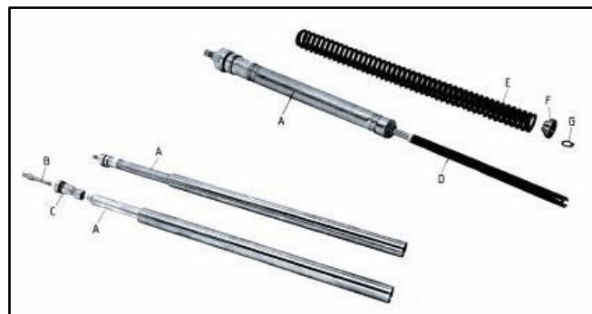
Figura 4.3. Piezas internas de la horquilla.
