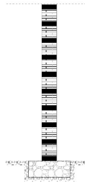
Figura 116. Zunchado fibra de carbono. Rehabilitar con acero.
