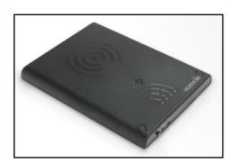
Lectores móviles. Dispositivos de mano. Incorporan una pantalla LCD, un teclado y una antena integrada dentro de una unidad portátil (su radio de cobertura es menor).
