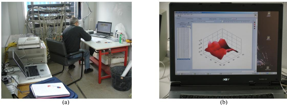
Fig. 3.29 Sistema adquisición y almacenamiento de datos (a) Disposición de los equipos en la caseta (b) Lectura en tiempo real del hormigonado del primer forjado
