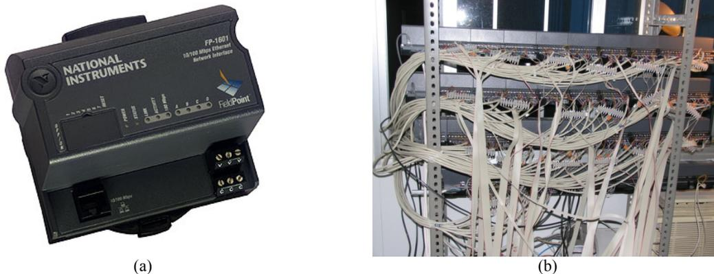
Fig. 3.28 Módulos de adquisición de datos (a) Módulo de red FP-1601 (b) Trenes de módulos de adquisición de datos con cables prolongadores a los instrumentos de medición
