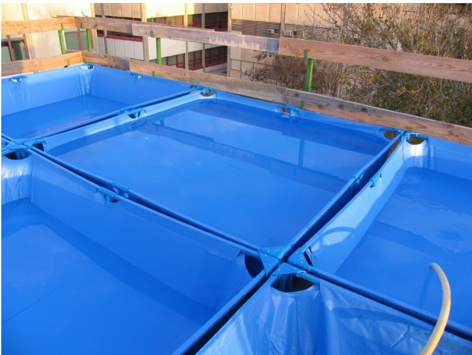
Fig. II.39 Llenado del las balsas plásticas para aplicar la carga en el forjado 3 (22/12/2006)
