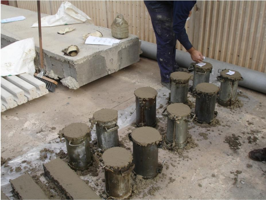
Fig. II.14 Probetas de hormigón curadas en las mismas condiciones que el forjado 1 (28/11/2006)
