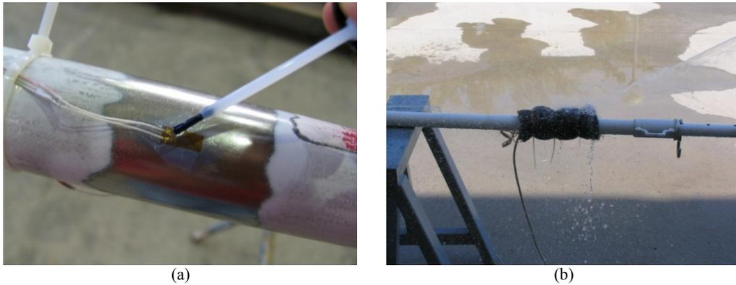
Fig. 3.19 Protección de bandas extensométricas (a) Aplicación del esmalte de poliuretano (b) Armaflex sometido a presión de agua
