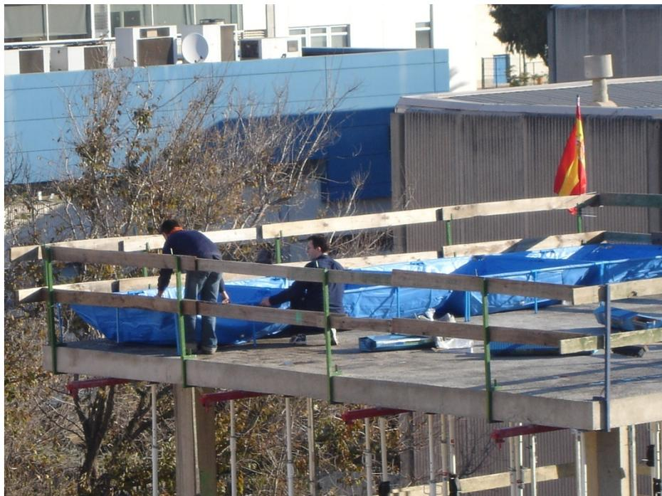
Fig. II.37 Instalación de balsas plásticas para aplicar la carga en el forjado 3 (21/12/2006)
