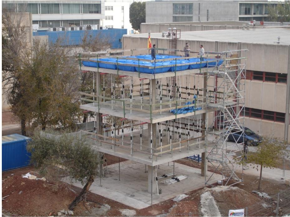
Fig. II.40 Aplicación de la carga en el forjado 3 (22/12/2006)
