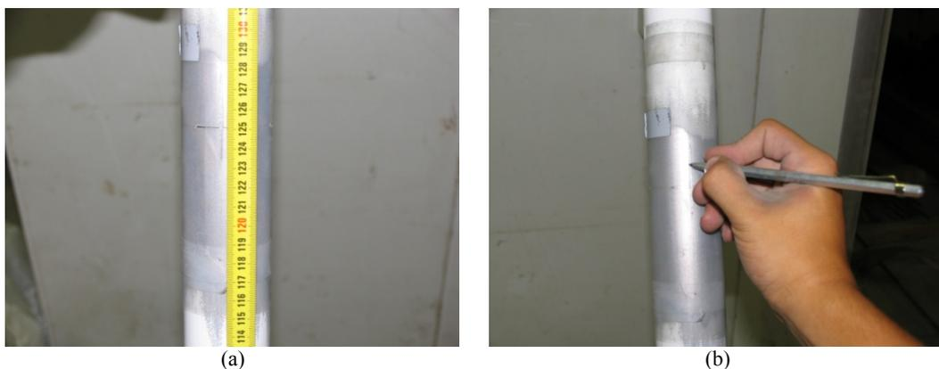
Fig. 3.17 Replanteo de bandas extensométricas (a) Posicionamiento de plantilla para el replanteo (b) Marcado de la superficie del puntal
