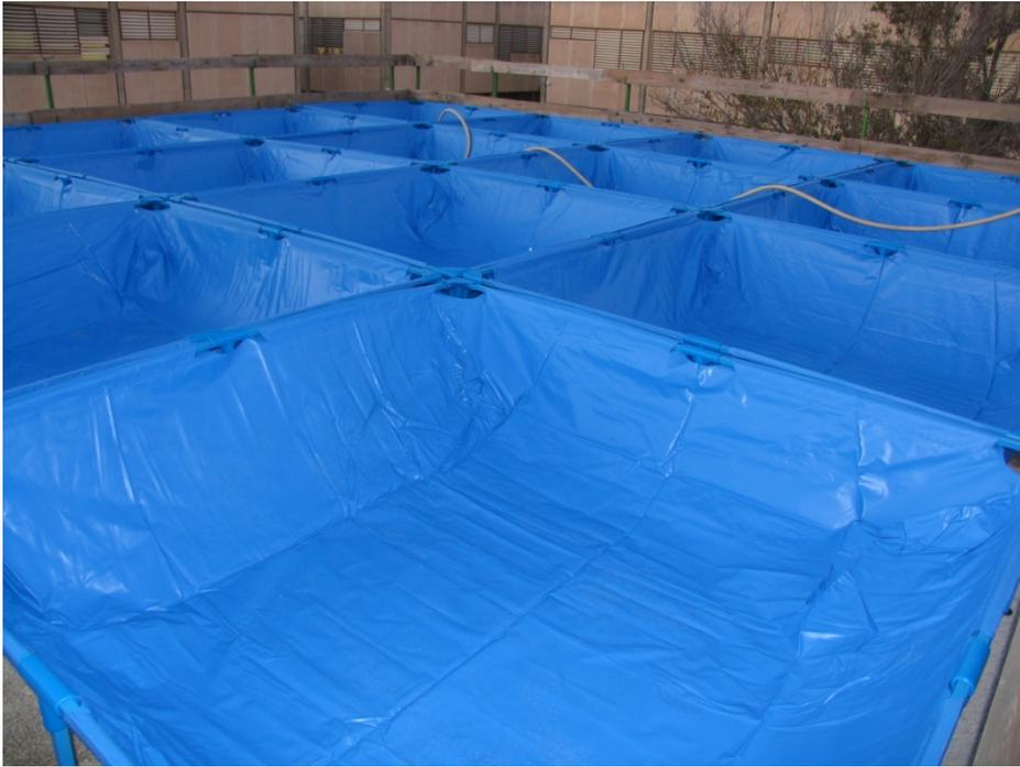
Fig. II.38 Balsas plásticas para aplicar la carga en el forjado 3 (21/12/2006)
