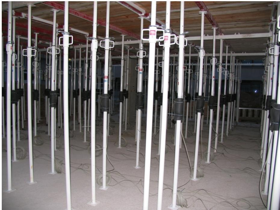
Fig. II.8 Disposición de cables en cada uno de los puntales instrumentados (24/11/2006)
