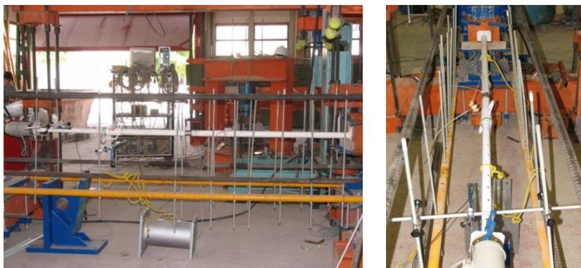
Fig. 3.30 Marco metálico y puntal listo para ser ensayado
