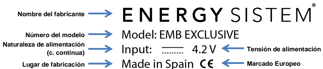
Figura 5. Etiqueta y significado de cada elemento que propone la norma “UNE-EN 60065.2015”
