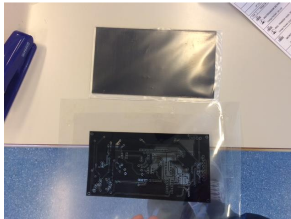
Figura 69. Arriba, placa para circuito impreso cubierta de un film protector contra luz ultravioleta, abajo circuito impreso sobre film transparente.
