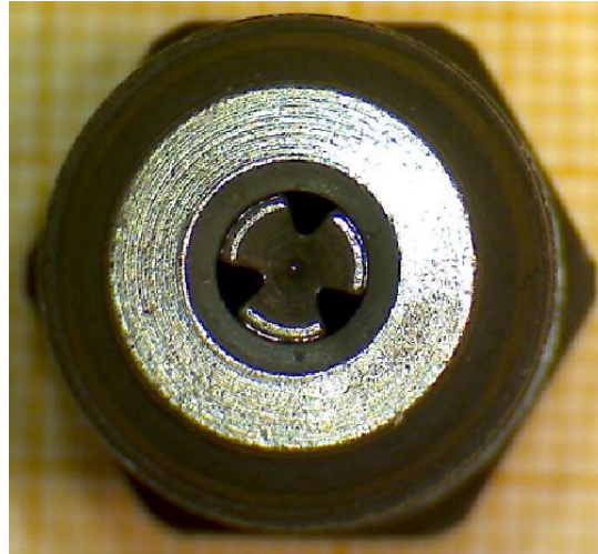
Ilustración 70: Orificios de salida de las líneas de entrada de combustible
