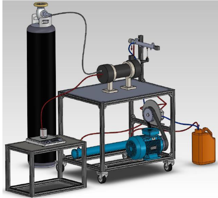
Ilustración 30: Modelo de la instalación de medición de la tasa de inyección de combustible
