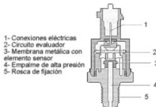
Ilustración 12: Sensor de alta presión del sistema common-rail
