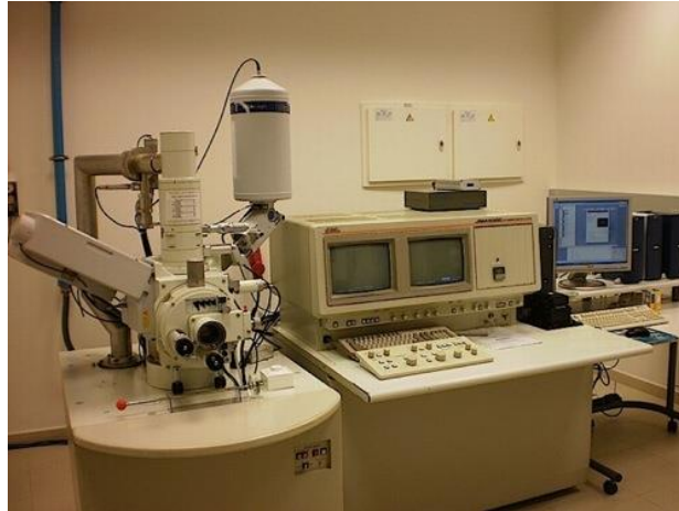
Ilustración 26: Microscopio electrónico de barrido JEOL JSM6300
